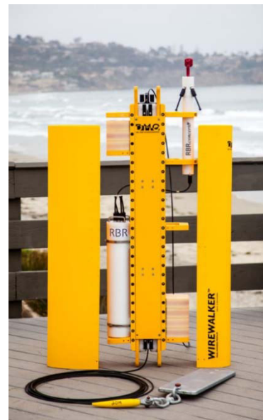
Figura 2. Fotografia de um Wirewalker (fonte: Del Mar Oceanographic)
