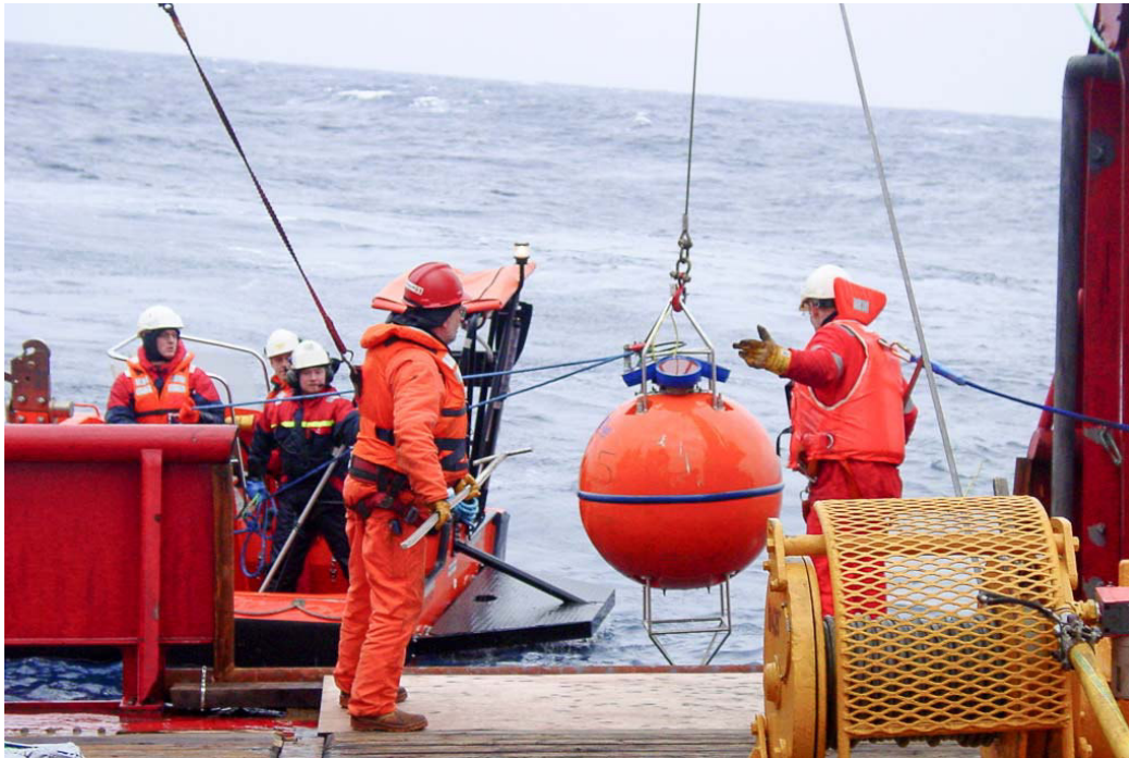
Figura 3. Boia de subsuperfície equipada com um ADCP de longo alcance. (Fonte: www.bornhöft.de )
