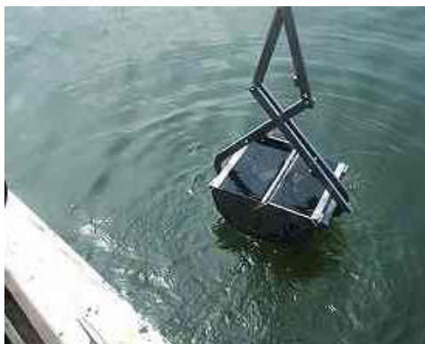
Figura 10 – Draga Ponar utilizada na recolha de amostras de sedimentos superficiais.
