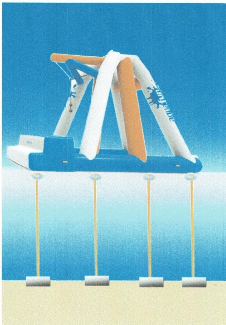
A ancoragem do parque será assegurada por maciços em betão armado, compostos pela mistura de cimento, agregados grossos e finos, água e aço armado, com base na NP EN 206-1 (DNA 5.3.1), o período de vida útil das estruturas de betão armado tendo em vista a sua durabilidade é de 50 anos.
