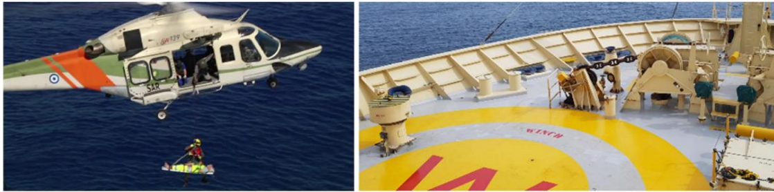
Figura 5: exemplo de evacuação médica de helicóptero (esquerda) e área de guincho em C/S Ile de Batz (direita)
