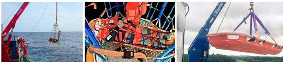
Figura 7: Exemplo de transferência de guindaste pessoal com cesta (esquerda), maca dentro da cesta (centro) e maca somente (direita)
