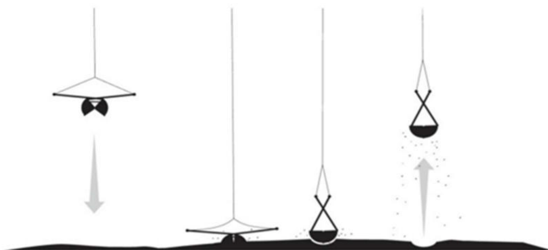
Figura 2. Da esquerda para a direita o modo de operação da draga Van Veen: lançamento, chegada ao fundo, fecho e recolha do sedimento (Gravura: Frederico Oliveira FCB/CCMAR).
