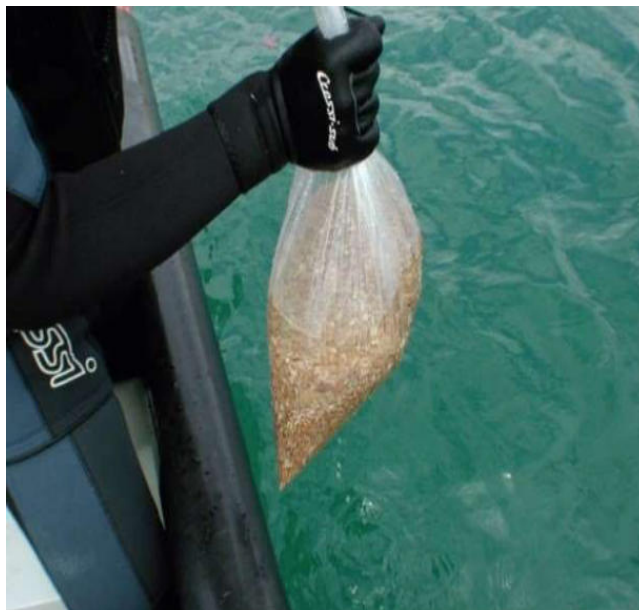
Figura 4 .A armazenagem das amostras recolhidas com draga-de-mão do tipo Van Veen (Imagem FCB).
