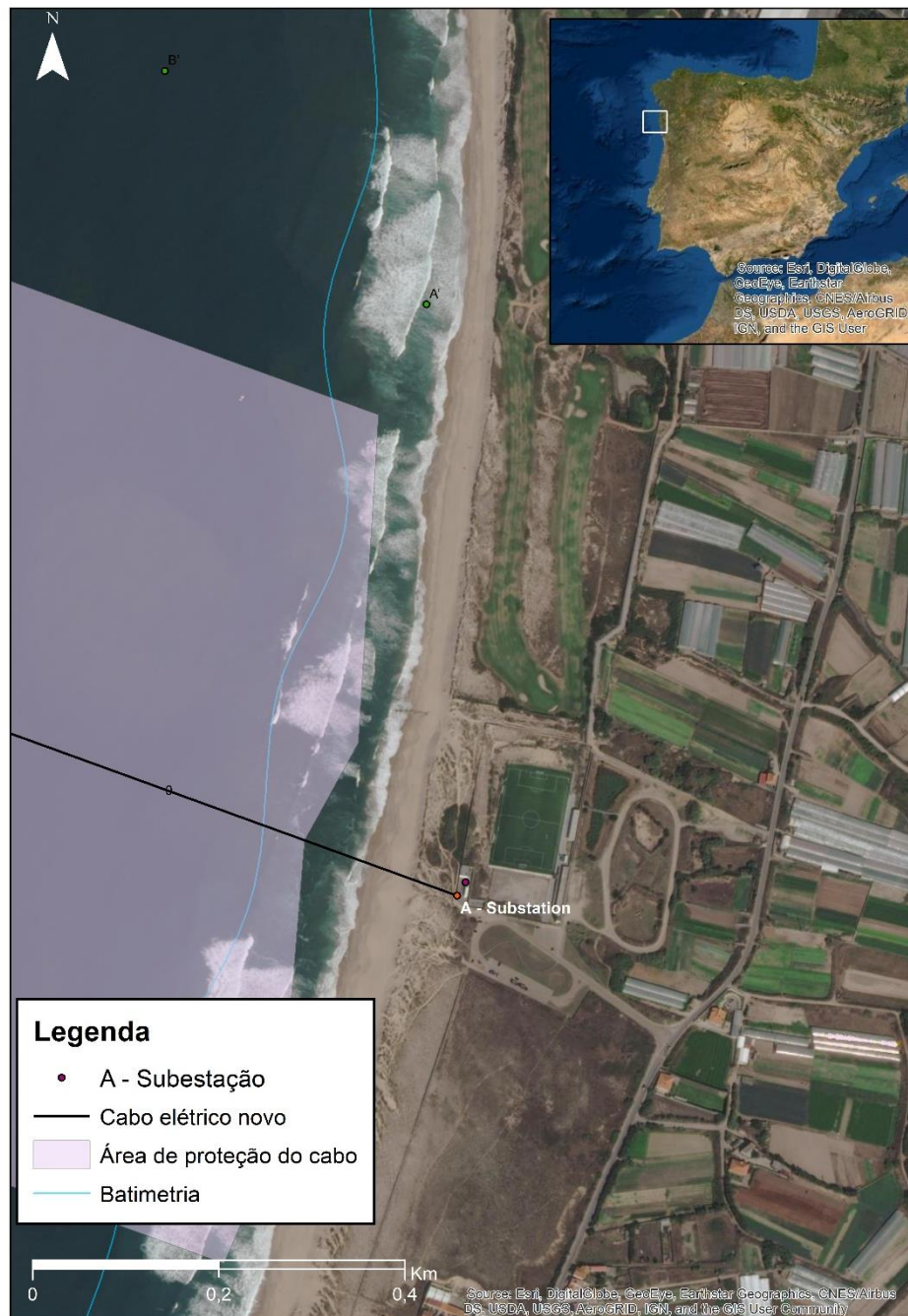
Figura 5 – Detalhe da localização da subestação em terra e rota de passagem do cabo até à subestação.
