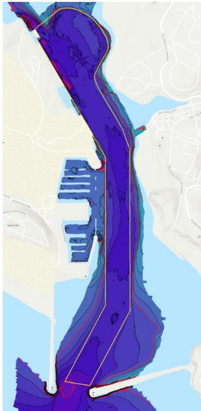
**Figura 2** Geometria do canal de navegação de Portimão.
