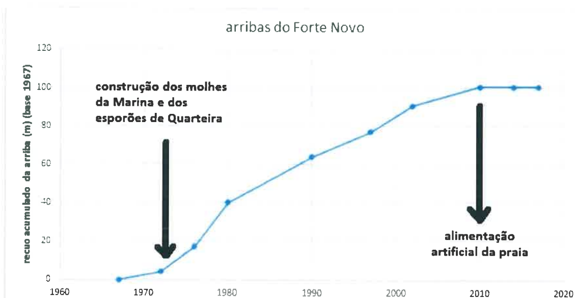
Figura 13 – Efeito das intervenções no recuo das arribas do Forte Novo (1967-2017)
