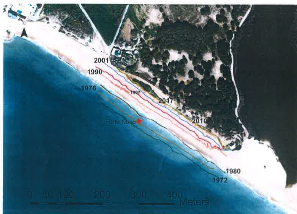
Figura 12 – Evolução espacial da crista da arriba no Forte Novo, entre 1972 e 2017 (base ortofoto de 2014)
