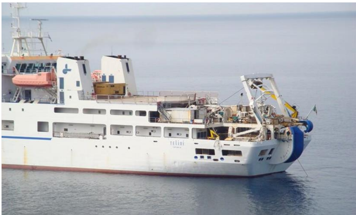
Fig. 10: Navio de instalação do cabo submarino com ponte-grua à popa, enquanto procede à largada do cabo pela borda.
