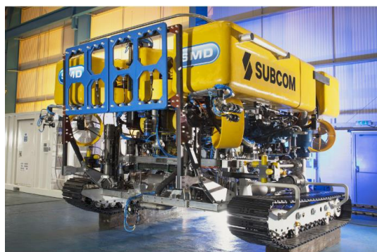
Figura 5.3.8 - Exemplo de um veículo operado remotamente (ROV) (Fonte: SubCom, 2024)
